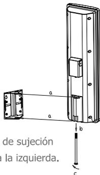
Afloje el tornillo de sujeción con vuelta hacia la izquierda.
